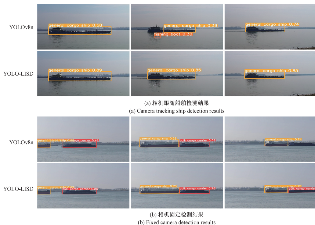
图 10 YOLOv8n 与 YOLO-LISD 动态检测效果对比
