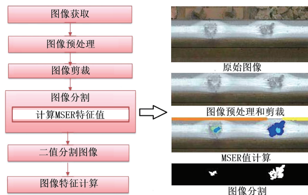
图 13 基于 MSER 技术图像分割流程 [86]
