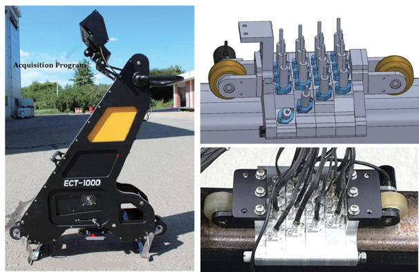
图 10 多通道涡流检测装置 [61]
