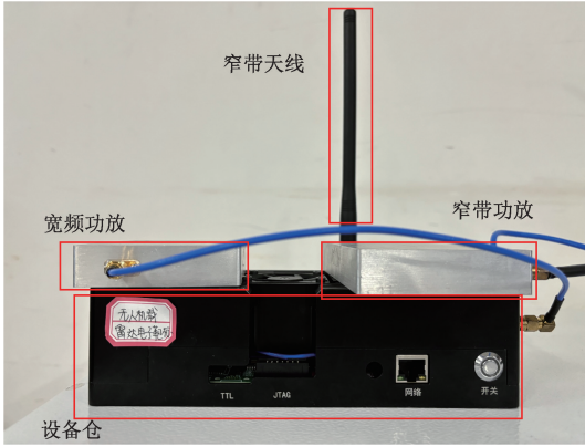
图3 雷达波形模拟电子靶标系统实物
