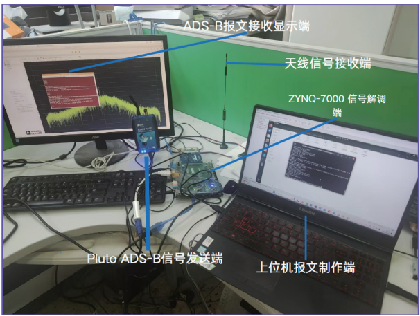
图 7 PlutoSDR 发送 ADS-B 信号测试
