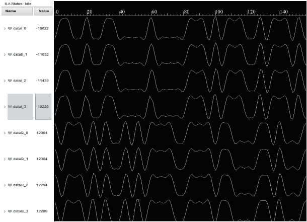
图 13 FPGA 发往 CX8242K 的四路 I/Q 信号
