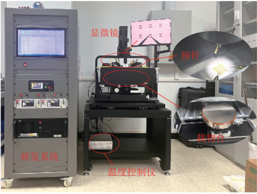
图 12 TSV 电迁移可靠性试验平台 Fig. 12 Electromigration reliability test platform of TSV
