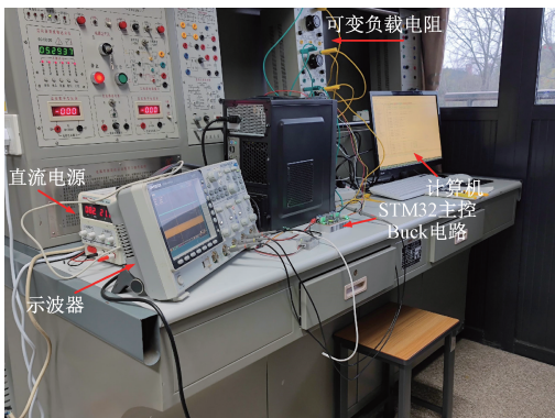
图 6 同步 Buck 变换器控制系统实验平台
