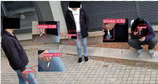
图 15 改进的 YOLOv7 可视化检测效果
