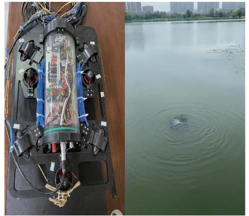
图 21 超声波水下定位试验环境
