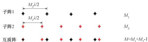
图 1 互质极化敏感线阵结构( M_1=4, M_2=5 )
