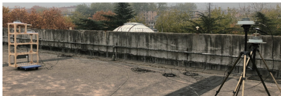
图 11 双节点无线时间比对实验天线架设照片
