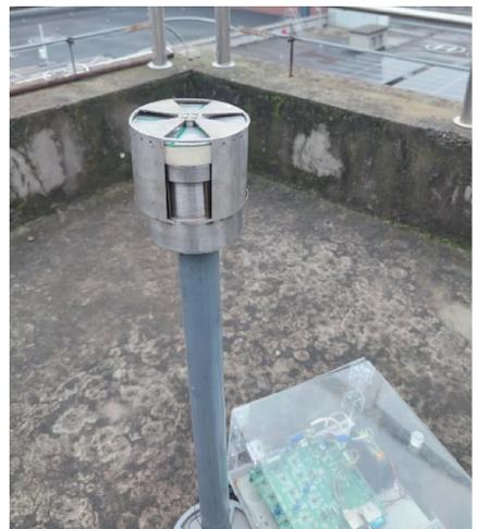
图10 电场传感器室外测量图
