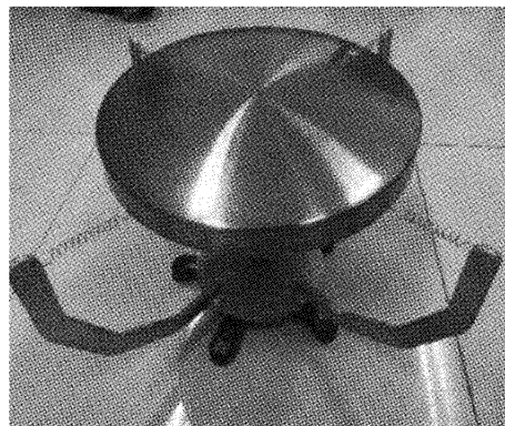
图 1 冰雹拾音装置
