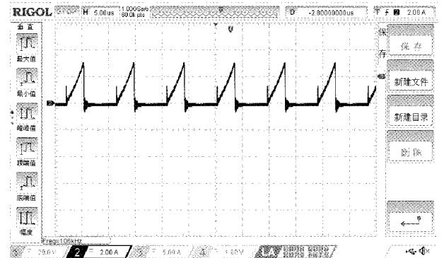
图 10 轻载时变压器原边电流
