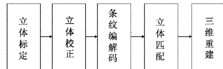
图1 双目结构光视觉系统主要框架
