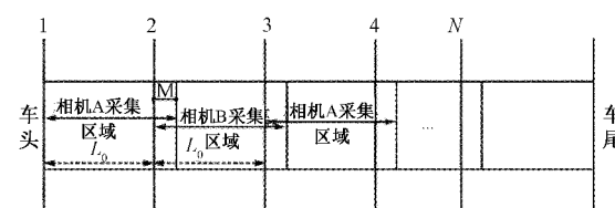
图8 相机扫描车顶区域示意图
