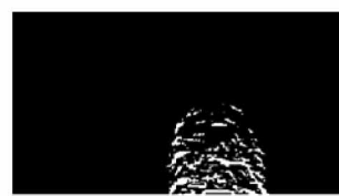
图 7 瘀伤缺陷边缘细化后结果
