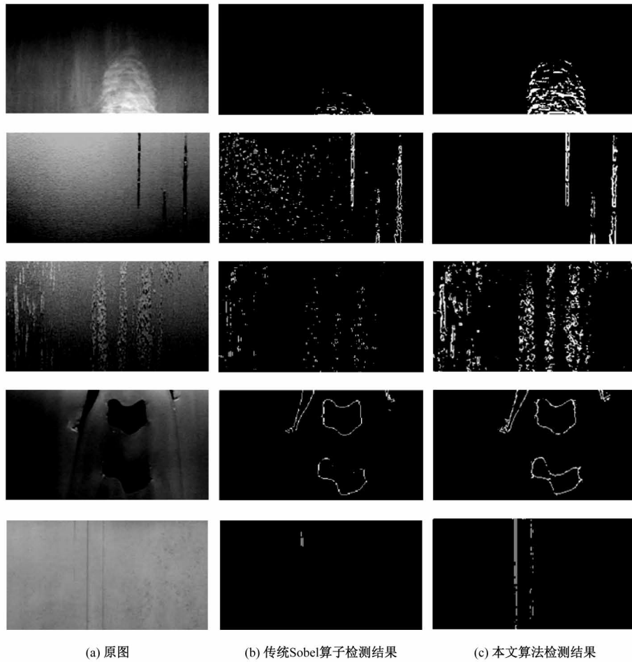
图 8 本文算法与传统 Sobel 算子边缘检测结果对比
