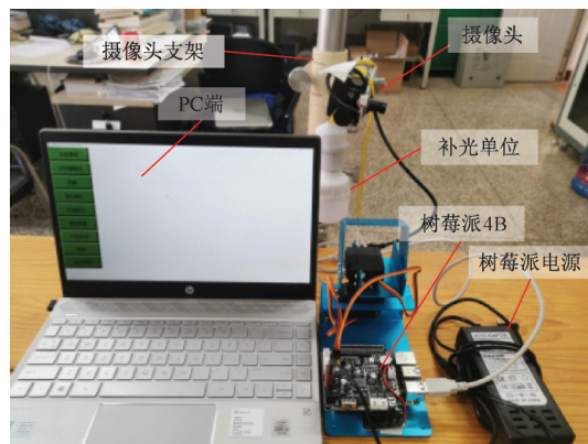
图 9 计量检定实验室仪表读数自动识别系统硬件实物
