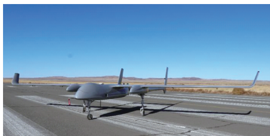
图 7 HW-350 小型长航时无人机平台
