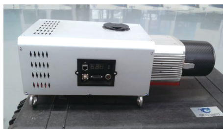
图 9 GL-70 机载激光雷达
