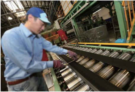
图 1 轮胎半成品挤出部件人工检测
