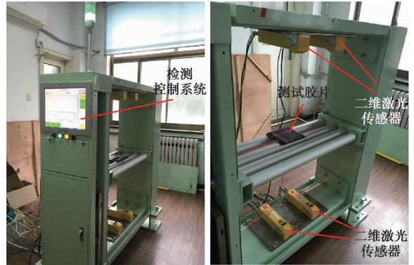
图 10 轮胎半成品挤出部件检测装置实验
