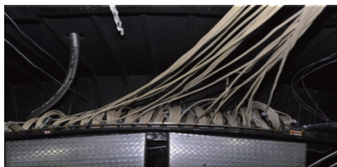
图1 容器内加热电缆示意图
