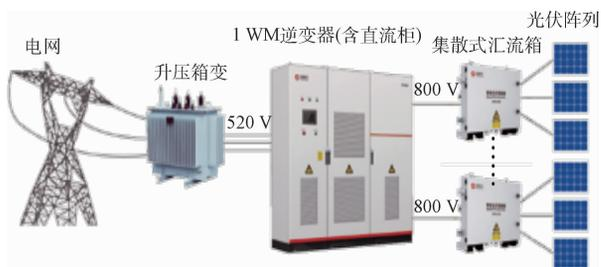
图6 1 MW光伏发电系统
