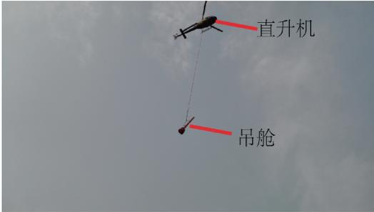
图 1 直升机机载航磁测量系统
