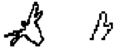
图 11 截面轮廓点与爬距的有效轮廓点
