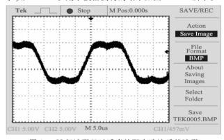
图 10 U 相波形经过适当的阻容滤波后的波形
