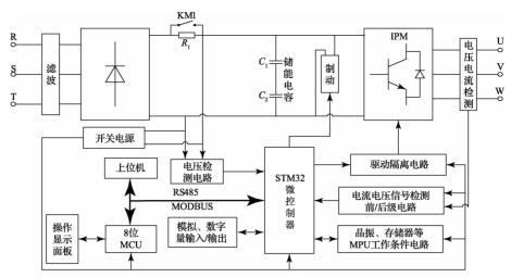
图 2 变频器基本结构
