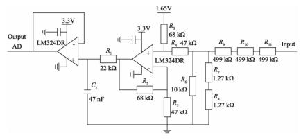
图 5 电压采集信号调理电路
