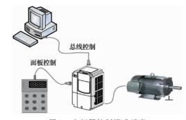
图 1 变频器控制模式示意
