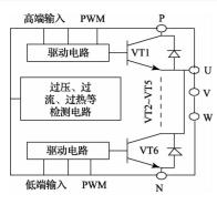
图 4 IPM 内部结构
