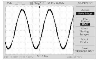
图 11 50 Hz 时定子电流 U 相的波形
