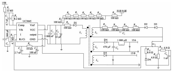
图 3 开关电源硬件结构
