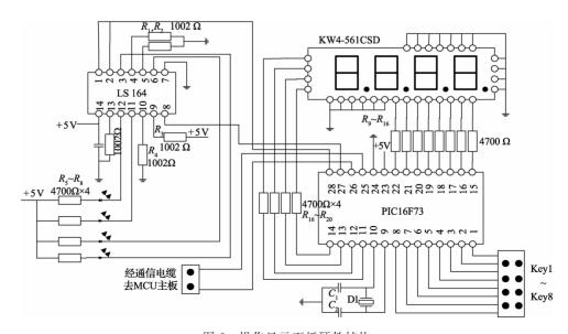
图 6 操作显示面板硬件结构
