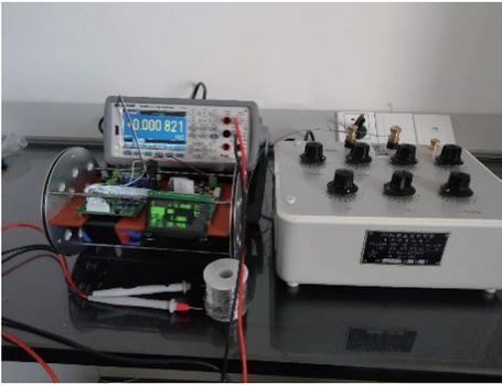
图 7 信号调理电路测试系统
