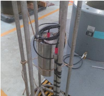
图 8 耐压测试封装图
