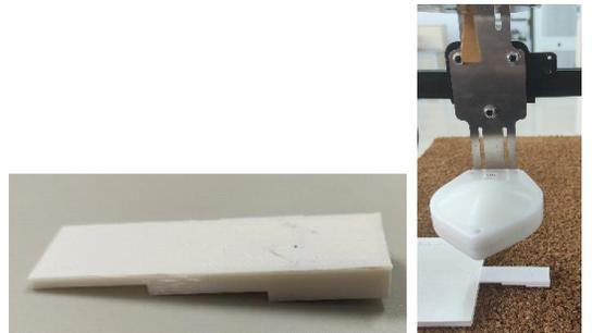
图5 3D 打印厚度检测板样件图及检测
