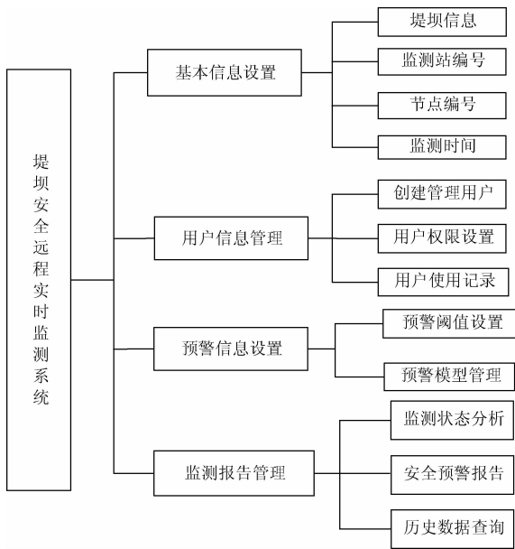
图 8 堤坝边坡远程监控管理功能设计
