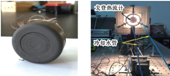
图 14 嵌入式热流测试装置及校准试验系统
