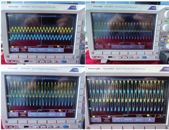
图 12 高温漏电干扰实测图
