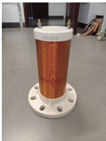
图 14 电感值为 300 \mu\text{H} 的传统螺线管型电抗器
