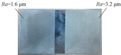
图 17 不同表面粗糙度的铁基
