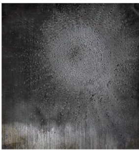
图 6 超高速撞击试件
