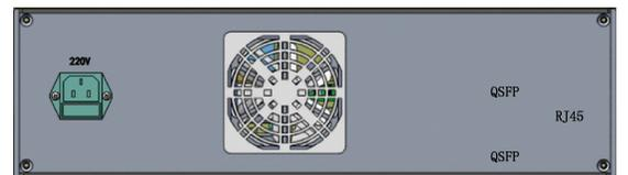
图 9 软件定义高速采集回放平台后面板示意图
