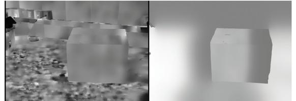
(a) SGBM 立体匹配视差图 (b) 自适应 GrabCut 的 SGBM 算法
