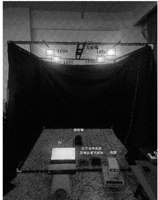
图 7 RSS 可见光定位实验图
