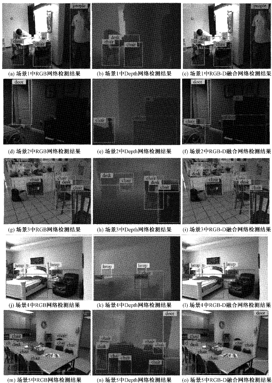
图 4 NYU Depth v2 数据集中 5 个场景的 RGB-D 目标检测结果
