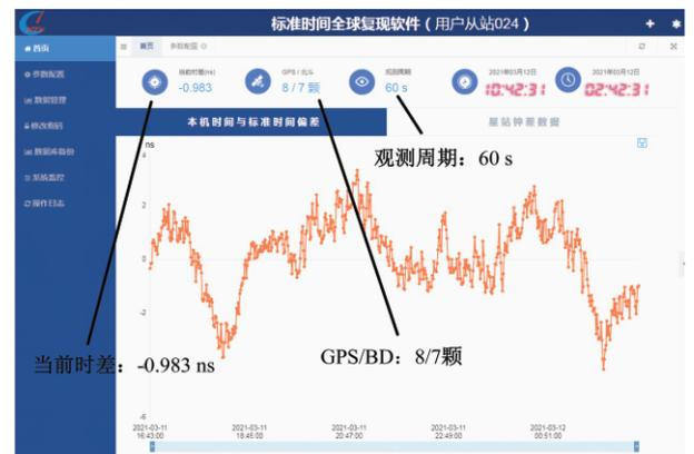
图6 主控模块软件主界面
