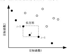
图 7 拥挤度算子示意图
