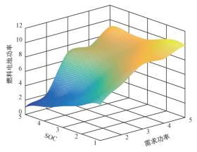
图 6 模糊控制器输出曲面
