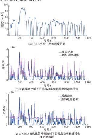
图 10 UDDS 典型工况下的需求功率和燃料电池 功率曲线对比
