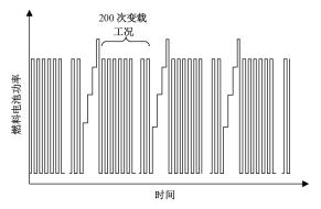
图 4 燃料电池变载典型循环工况示意图
