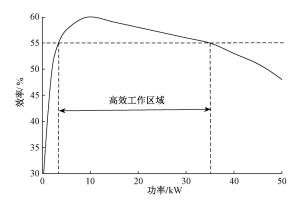
图 2 燃料电池的功率-效率曲线
