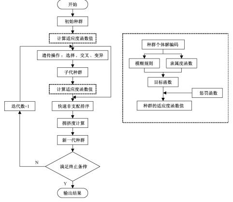
图 8 多目标遗传算法 NSGA-II 优化模糊控制流程
