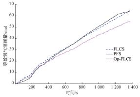
图 11 各控制策略下的等效氢气消耗量
