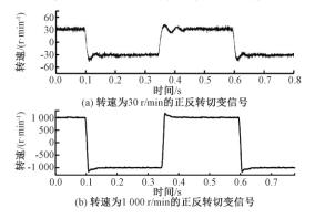
图 14 双正弦变密度条纹测量得到的不同转速切变信号[17]
