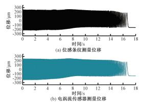
图 9 X 方向时域位移测量结果对比
