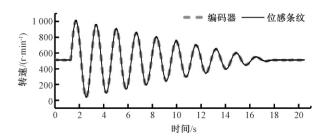
图 13 双正弦变密度条纹测量得到的转速幅值线性 减小的正弦变转速信号[17]
