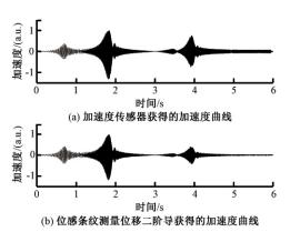
图 4 扫频激励下悬臂梁 X 方向的加速度信号
