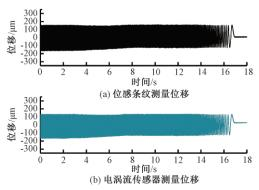
图 10 Y 方向时域位移测量结果对比
