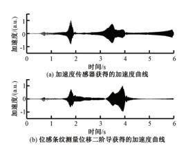
图 5 扫频激励下悬臂梁 Y 方向的加速度信号
