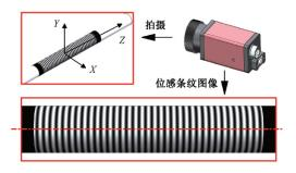
图 7 单密度位感条纹转轴三维振动位移测量
