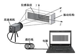
图 2 单密度位感条纹三维位移测量原理
