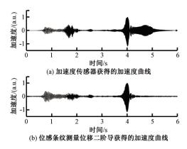
图 6 扫频激励下悬臂梁 Z 方向的加速度信号
