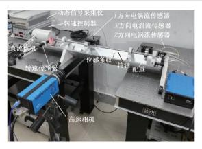
图 8 转轴三维振动位移测量实验装置
