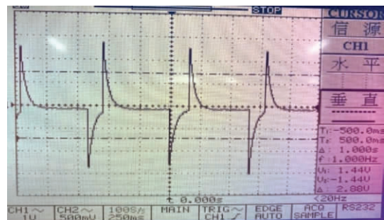
图 6 单级运算放大心率波形
