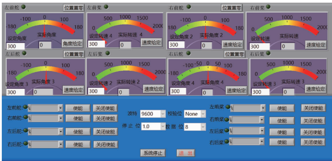
图 7 航行平台动力控制系统程序前面板
