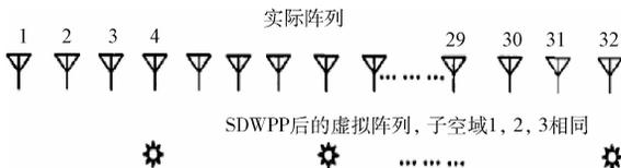
图 4 SDWPP 产生的虚拟阵列示意图
