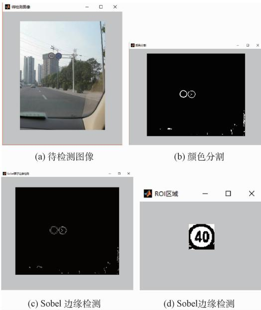
图 2 基于颜色和形状交通标志检测流程
