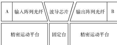
图1 光电子器件封装过程
