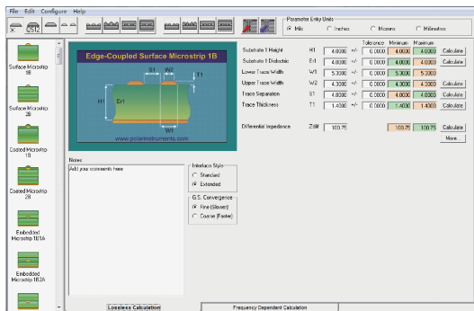
图 1 表层差分阻抗计算模型
