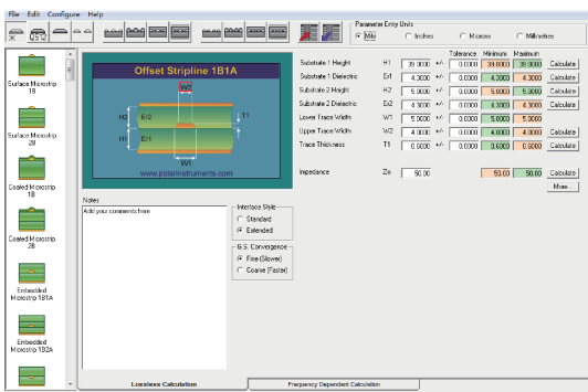
图 4 内层单端阻抗计算模型
