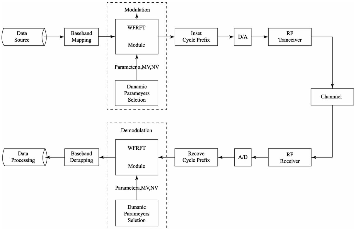
图 1 WFRFT 通信系统框图
