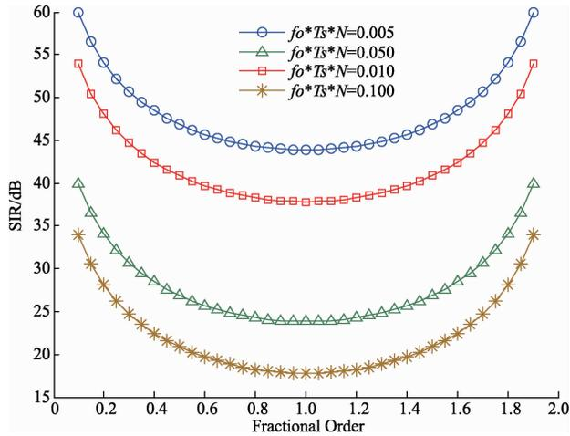
图 2 不同频偏条件下系统 SIR 与调制阶数的关系
