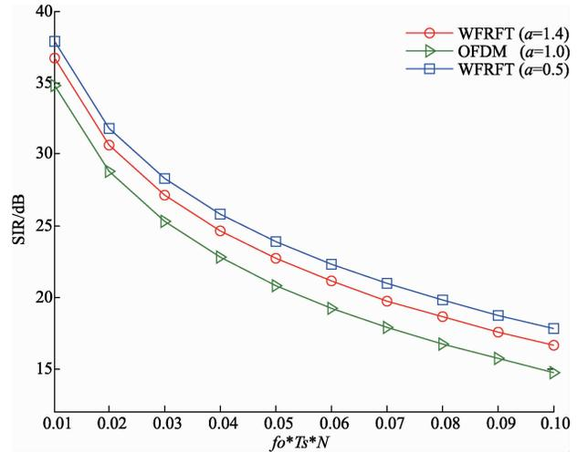
图 3 不同调制阶数下系统 SIR 与频偏的关系
