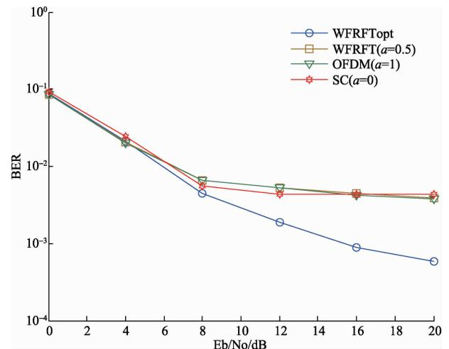
图 4 不同分数阶次系统误码率与信噪比的关系
