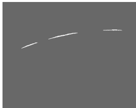
图 3 典型漏光缝隙图像
