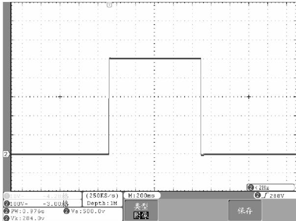
图1 线缆测试仪直流高压测试波形
