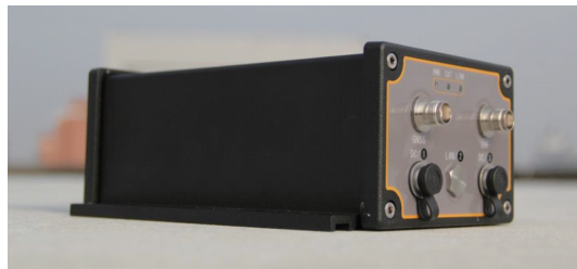
图3 司南M300C型接收机
